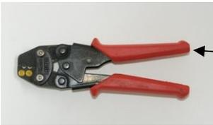
圧着工具 確実に圧着端子を圧着できます。
