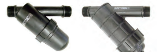
AKY382 メッシュサイズ：60・80・120# 最大流量：83.0L/分 最高使用圧力：0.6MPa 接続口径：20mm ※ステンレスメッシュ付き ※ソケット別売
