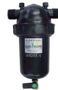
AR311 メッシュサイズ：40・80・120・140・200# 最大流量：100.0L/分 66.6L/分 (200#) 最高使用圧力：1MPa 接続口径：25mm ※ドレインバルブ付き
