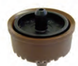
PL-STND3.8 推奨ノズル：黒 散水量：3.8L/時
